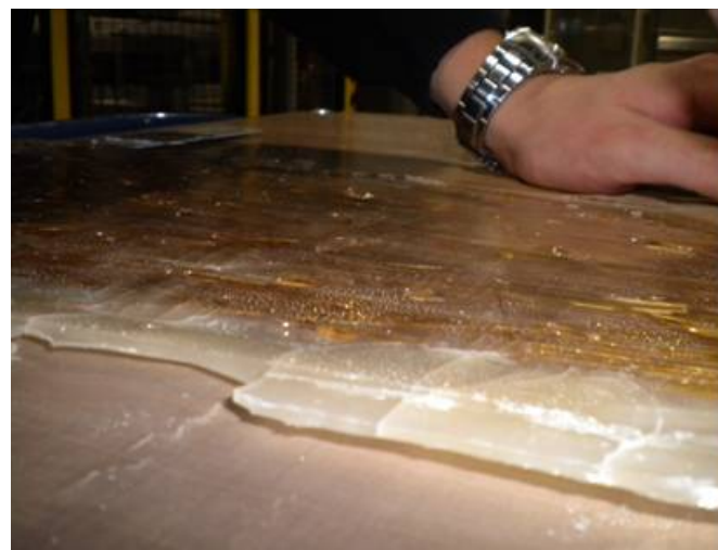
PLA und Bambus „Sandwich“ Faserverbundwerkstoff aus PLA und Bambus
