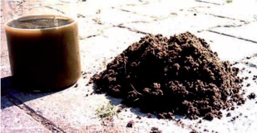
Zentrat (li.) und Konzentrat (re.) nach der Separierung
