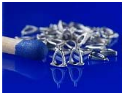
Replikate des Steigbügels hergestellt durch Mikro-Metallpulverspritzgießen
