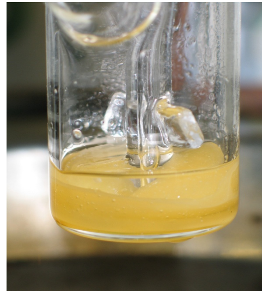
Celluloselösung einige Minuten nach Zugabe des Silylierungsreagenzes
