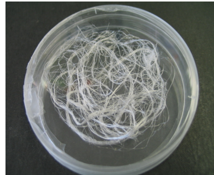
Celluloseacetatfasern erhalten durch Direktverspinnung aus BMIMCl
