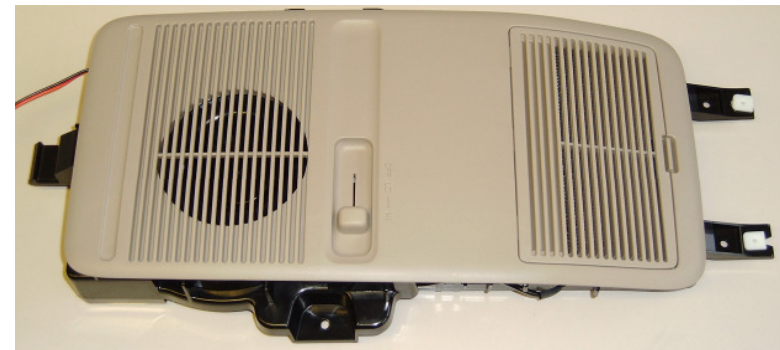
Katalysatorschüttung mit UV-LED's (Toyoda-Gosei)
