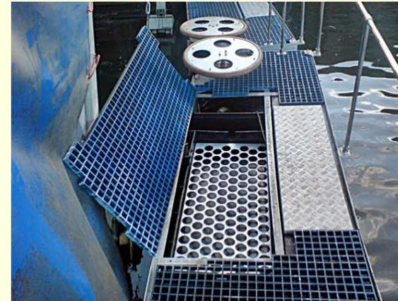
*In der Maschine sind vier Auffangbecken integriert. Ein austauschbares Filterfließ hält die abgereinigten Partikel zurück, das gefilterte Wasser fließt über Gravitation weg.*
