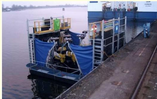
*Die rotierenden Reibräder sind zusätzlich drehzahl-gesteuert, um die Durchlaufgeschwindigkeit dem Bewuchsgrad anzupassen.*
