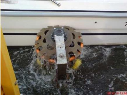
*Das zusätzlich mit Filzscheiben bestückte Bordwandbürstenpaar wird mit Umgebungswasser benetzt. Durch einen Schwenkmechanismus passen sich die Bürsten automatisch unterschiedliche Bootsrümpfe an.*
