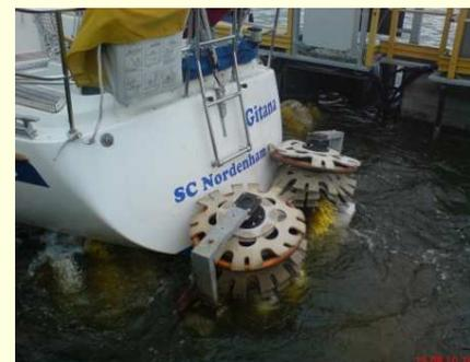
*Über einen manuell bedienenden Joy-Stick kann das Bordwandbürstenpaar den Spiegel reinigen.*
