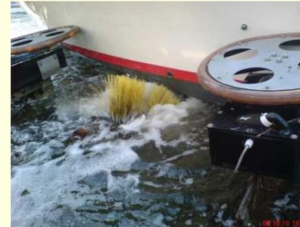
*Rotierende Reibräder zentrieren die Boote über die drehenden Bürsten und schieben dabei automatisch die Boote durch die Maschine.*
