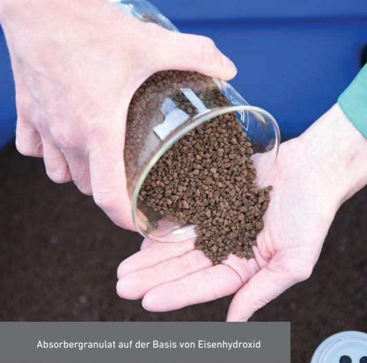
Absorbergranulat auf der Basis von Eisenhydroxid
