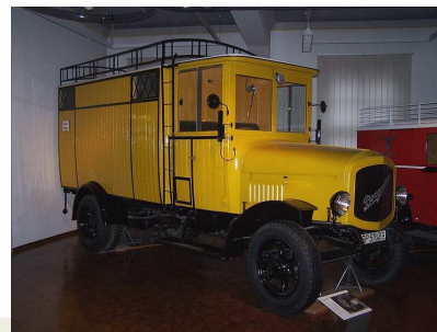
Bergmann-Paketzustell-Wagen mit Elektromotor, gebaut zwischen 1922 und 1927, Leistung 20 PS, Geschwindigkeit 20 km/h, Nutzlast 2,5 t, im Museum für Kommunikation in Nürnberg
