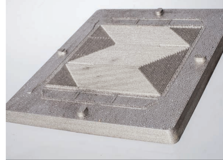
Die Bipolarplatten werden in einer 3-D-Druck-Form gepresst.
