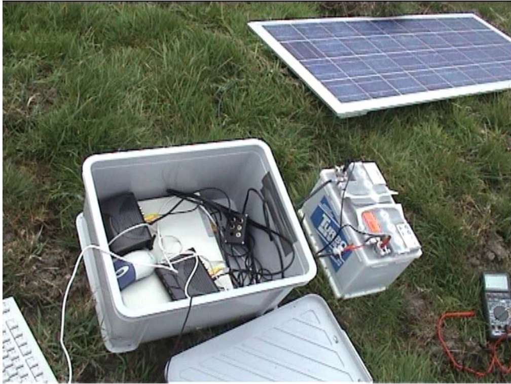
Abb. 5: Die Videoanlage im Feldeinsatz. Die Abdeckung der Technikbox und der Batterie wurden entfernt.
