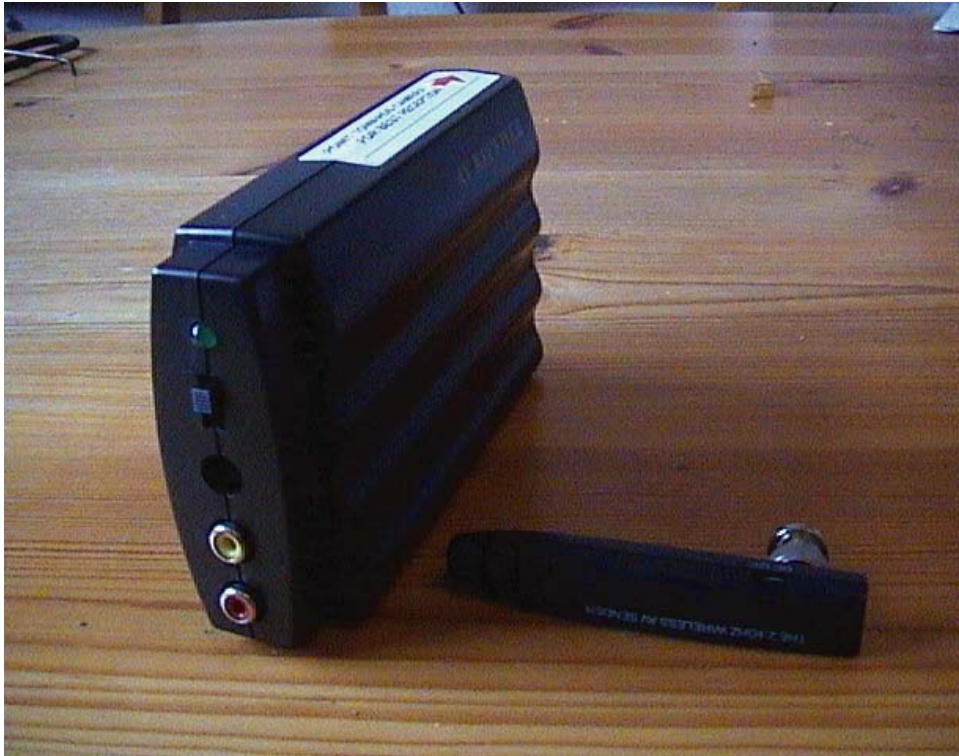
Abb. 3: 2,4 GHz-Set für die Funkübertragung zwischen normalerweise kabelgebundenen Kameras und dem Aufzeichnungsgerät.
