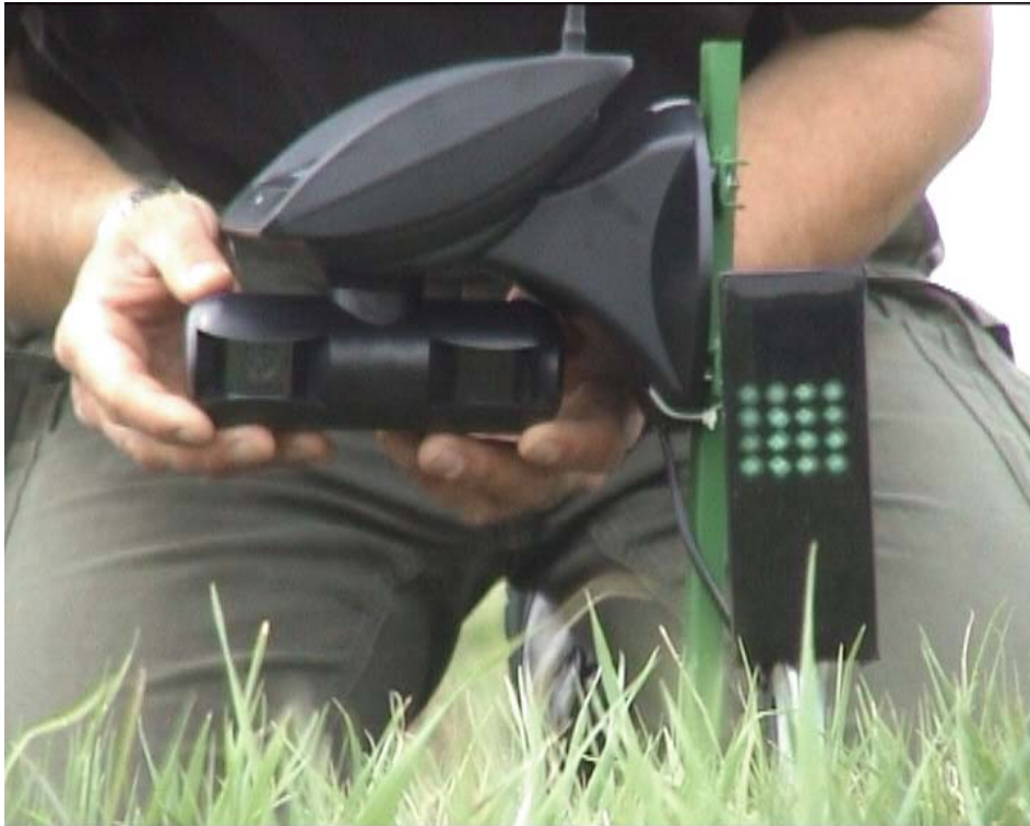
Abb. 2: Funk-Solar-Kamera mit zusätzlichem Infrarotscheinwerfer für Nachtaufnahmen.
