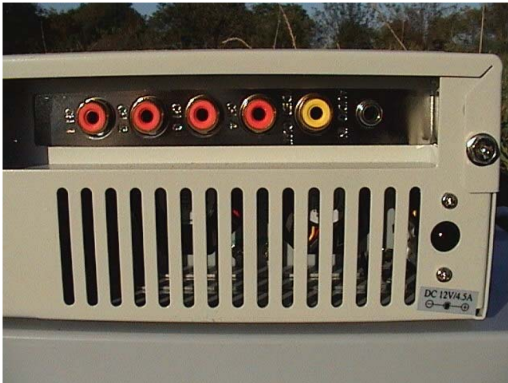
Abb. 4: Rückansicht des barebone-PC's mit vierfach-Videoeingangskarte.
