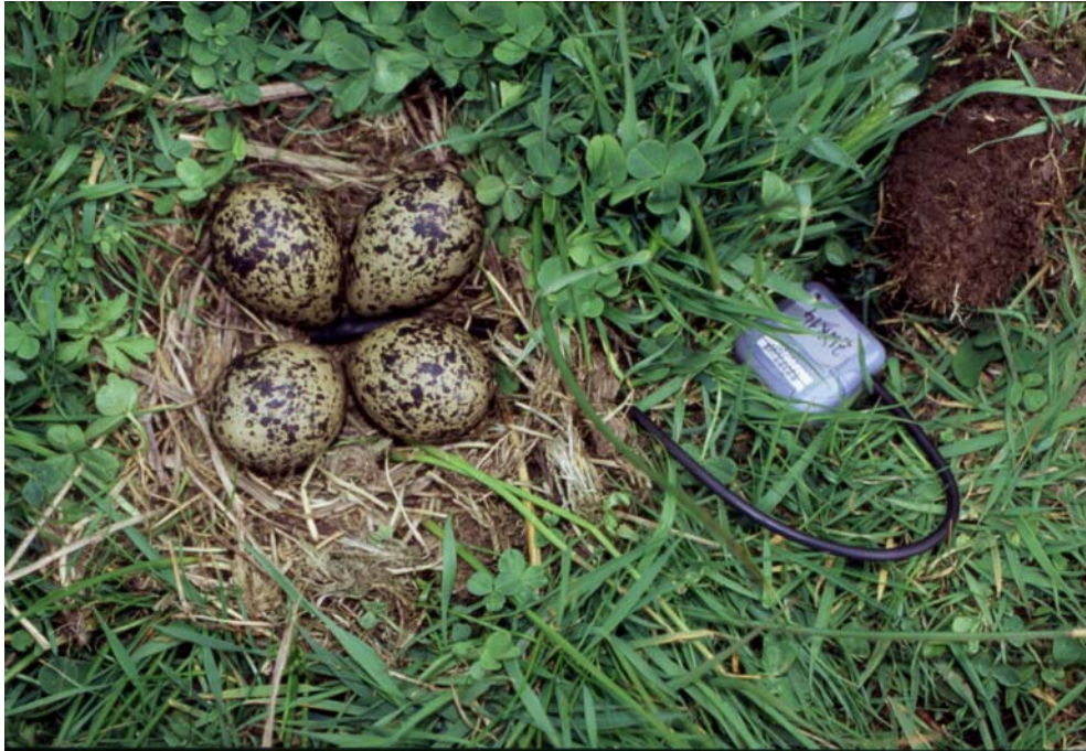
Foto 5: Einsatz eines Thermologgers an einem Kiebitzgelege, Logger und Messfühler sind zu Demonstrationszwecken freigelegt worden
