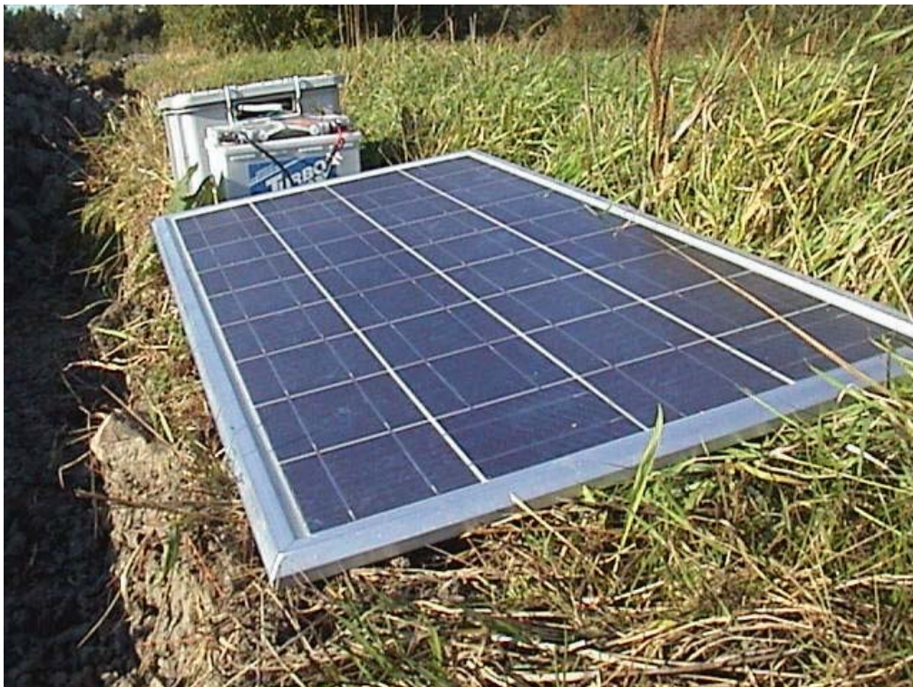
Abb. 1: Solarpanel zur Stromversorgung von Funkempfängern und bare-bone-PC.
