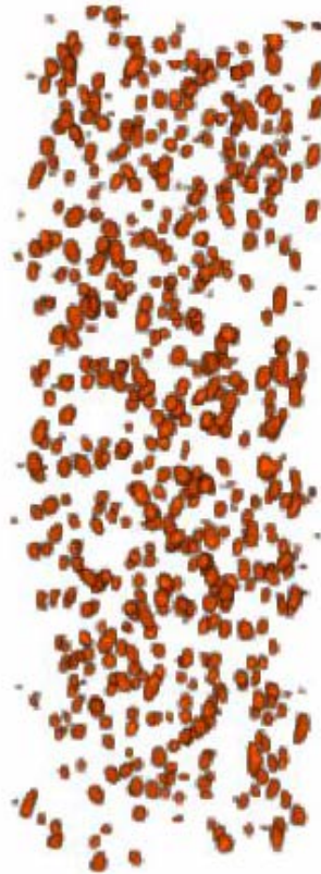
Tellerbelüfter Q = 6.3 \text{ sl/min}
