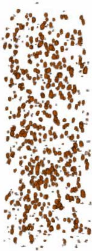
Kanülenbelüfter Q = 0.7 \text{ sl/min}
