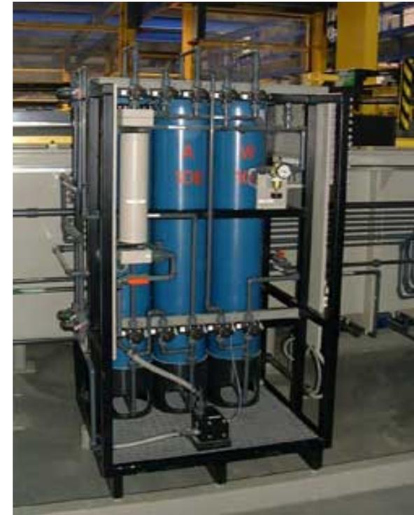
Säure-Retardationsanlage gebaut durch AW ELECTRONIC
