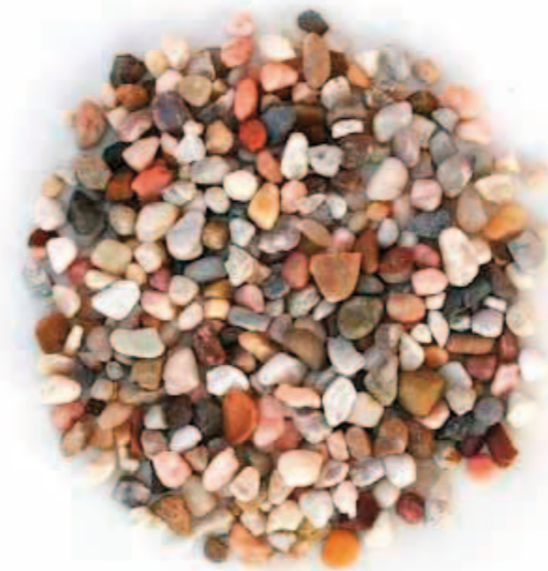
Trägermaterial für nitrifizierende Bakterien
