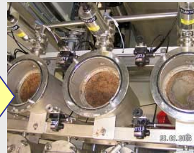
Pilot fermentor Type P, 450 L (Bioengineering AG)
