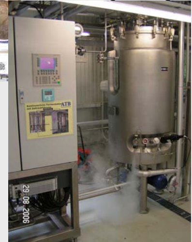
Pilot fermentor Type P, 450 L (Bioengineering AG)
