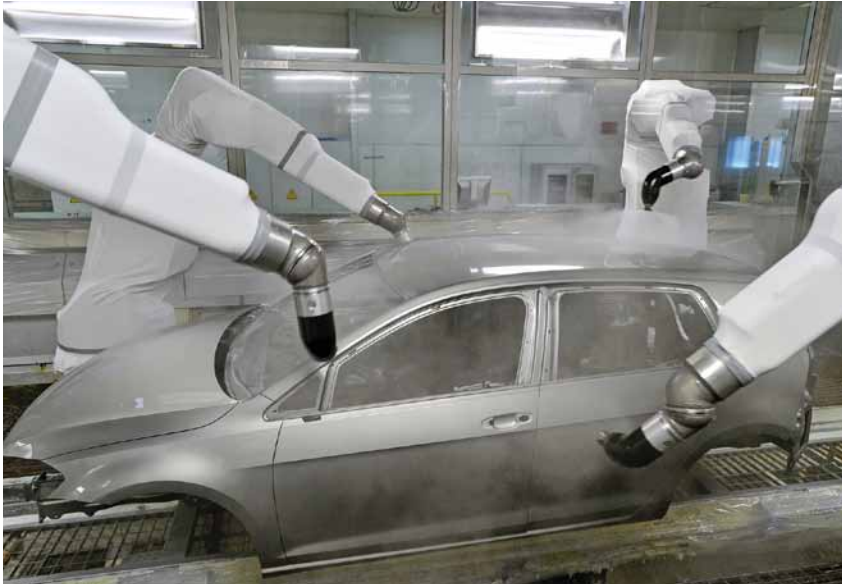
Für einen glänzenden Eindruck – die Lackierung einer Automobilkarosserie ist sehr energieaufwendig.
