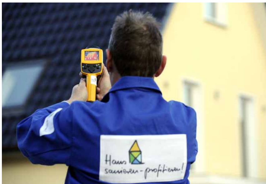
Einsparpotenziale im Blick: Eine Thermografiemessung offenbart »Wärmelecks« in der Gebäudehülle.
