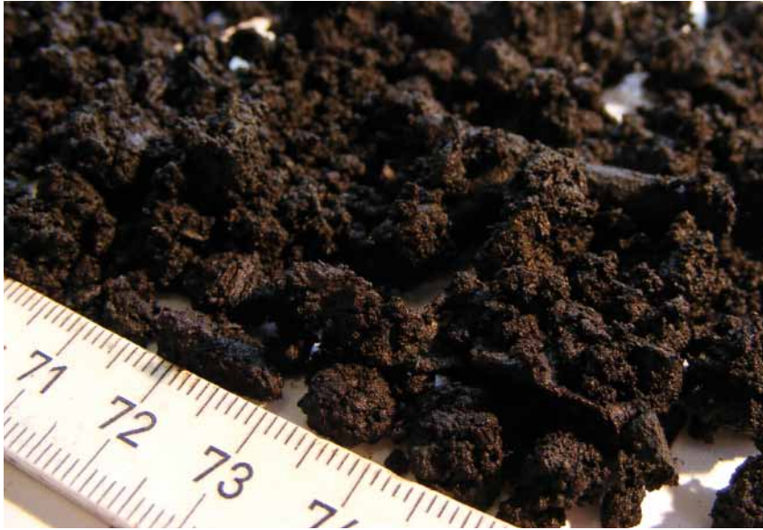
Sämtlicher Kohlenstoff, der im Pflanzenmaterial gebunden war, liegt nach dem HTC-Prozess in Form dieser »Biokohle« vor.
