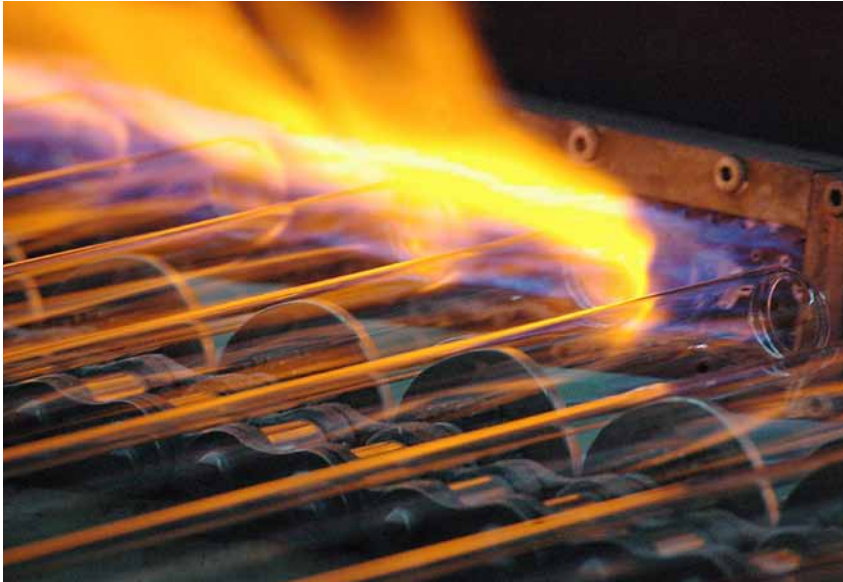
Die Narva-Vakuurröhren werden kostensparend aus Kalknatronglas gefertigt.
