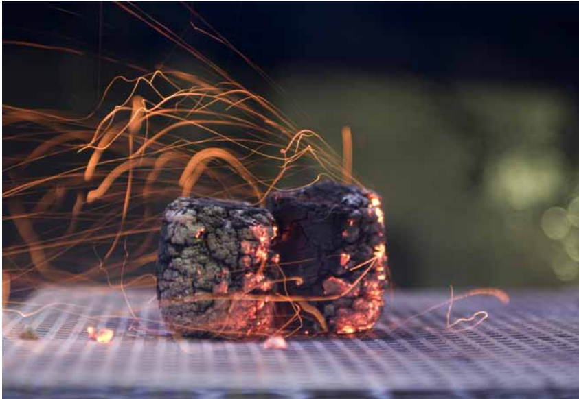
»Biokohle« als Produkt der hydrothermalen Carbonisierung ähnelt in der Zusammensetzung Braunkohle und ist als Brennstoff gut geeignet.
