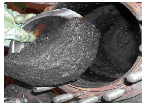
Biomasse plus Katalysator unter Druck und Luftabschluss auf 180 °C erhitzt, ergibt den Energieträger Biokohle.
