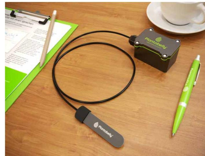
Die Vegetationssensoren lassen sich in jedes LoRaWAN einbinden und sind optimiert für aktuelle SmartCity-Konzepte.
