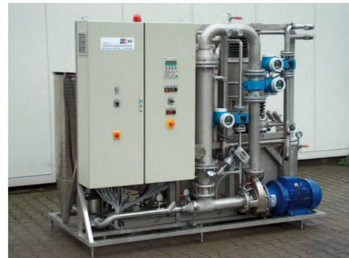
Ultrafiltrationsanlage der Firma A3 Water Solutions: Halbtechnische Versuche sind Teil des Projektes.
