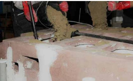
Vorbereitung für den Gussprozess: Der neue zementgebundene Formstoff wird in den Formkasten gefüllt.
