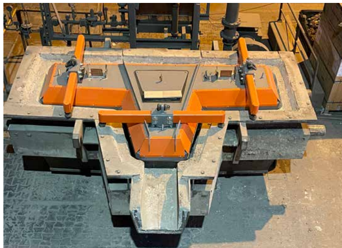
Die elektrisch beheizbare Schablone (orangefarben) des eMould-Systems: Sie bringt die feuerfeste Auskleidung in Form und erwärmt sie gleichzeitig durch elektrische Heizelemente (»Backprozess«).
