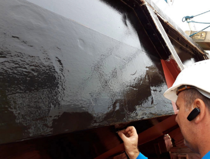
Applikation einer Antihafthtestfolie auf dem Arbeitsschiff »MÖWE« von bremenports
