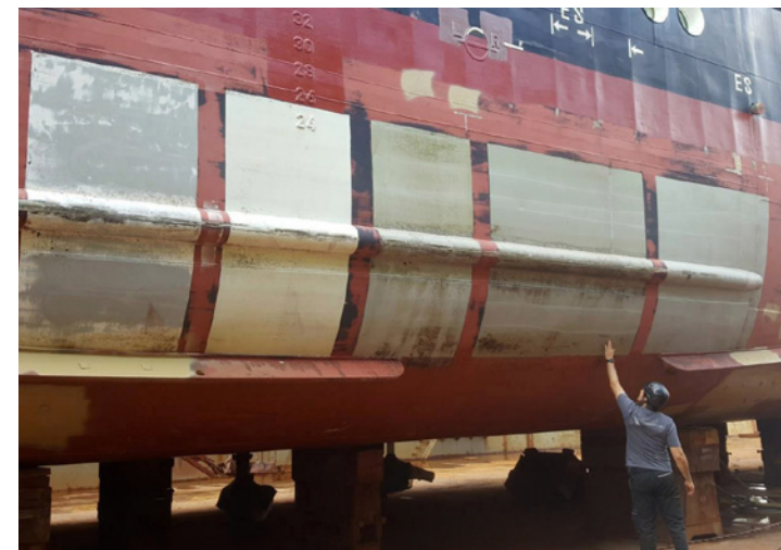
Antihaft-Beschichtungen auf dem Vermessungs-, Wracksuch- und Forschungsschiff »WEGA« des BSH nach Reinigung im Dock
