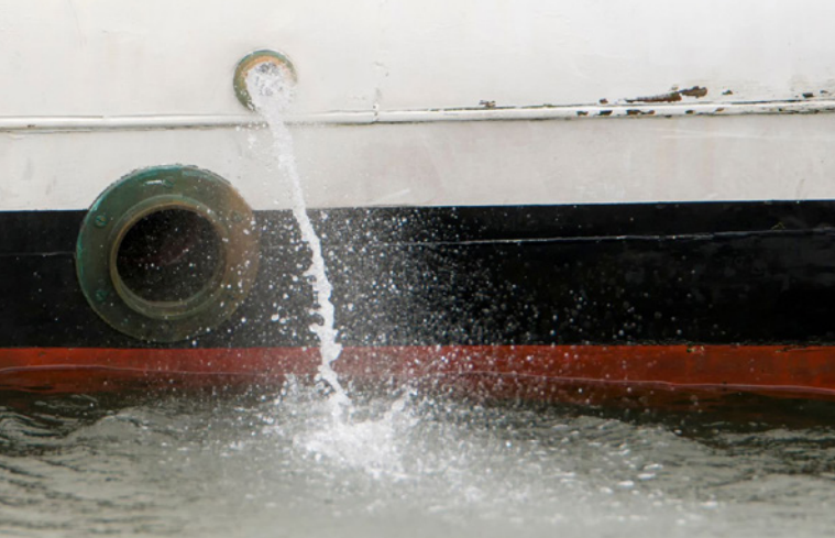
Austretendes Bilgewasser an einem Schiffsrumpf
