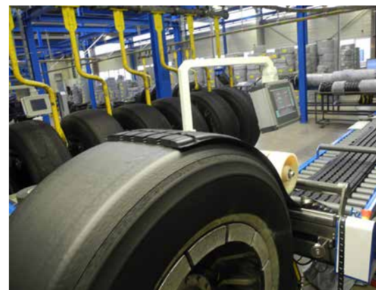
Bei der Runderneuerung wird eine neue Laufflächenmischung aufgetragen – danach sind die Reifen wieder wie neu.
