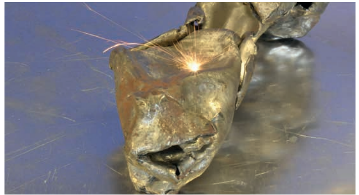
Schrottsortierung mit Laserlicht: Die Laserspektroskopie identifiziert die Legierungsbestandteile anhand ihres eindeutigen optischen Spektrums – wie ein »Fingerabdruck aus Licht«.
